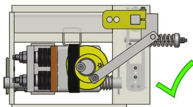
Achtung: Auslösehebel nach aussen Fangvorrichtung ausser Funktion
