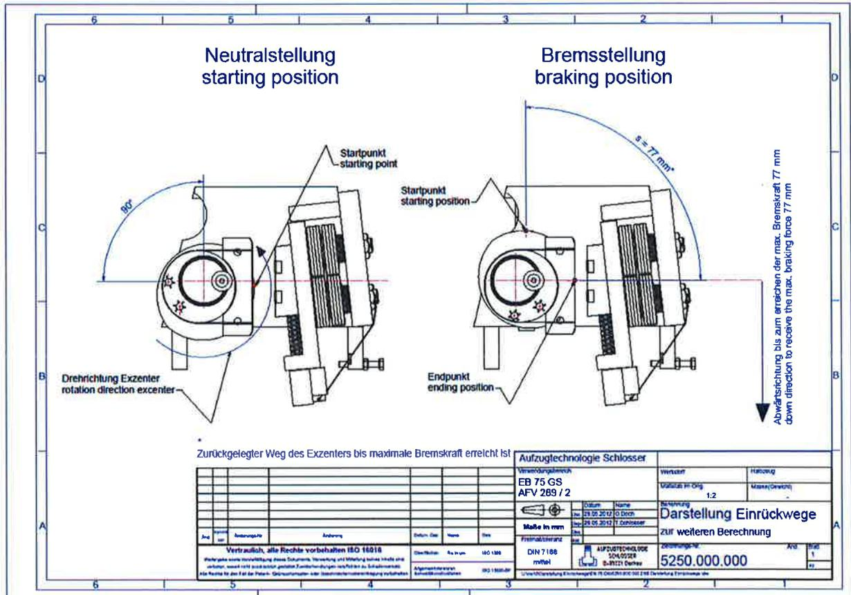
**Anhang 1B : Die Aktivierung Abstand von EB 75 GS Fangvorrichtung in Richtung nach oben mit Schlosser Aktivierungsmechanismus angewendet (Kombination mit KB55S).**
