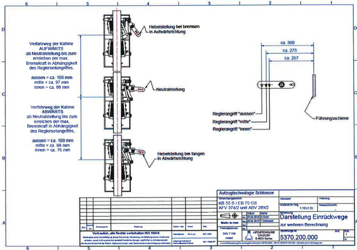
**Anhang 1C : Die Aktivierung Abstand von EB 75 GS Fangvorrichtung in Richtung nach oben mit Schlosser Aktivierungsmechanismus angewendet (Kombination mit KB55SS).**
